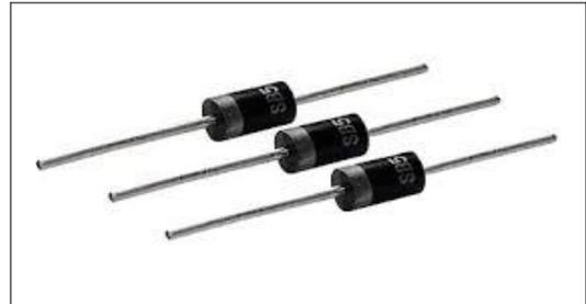
Las dos patillas reciben el nombre de ánodo (A) y cátodo (K), que es precisamente la marcada con esa banda. Para que el diodo deje pasar una intensidad I es necesario que le apliques al cátodo (K) una tensión negativa respecto a la del ánodo (A). Se dice que el diodo está “polarizado directamente”. En caso contrario la intensidad que circula a su través es nula ( $I = 0$ ). Se dice que el diodo esta “polarizado inversamente”.
