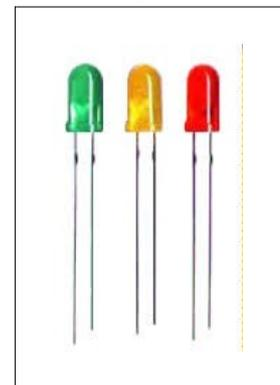
Su funcionamiento es similar al de un diodo convencional. Tiene dos patillas o electrodos: el ánodo (A) y el cátodo (K). Cuando se le polariza directamente (el cátodo es negativo respecto al ánodo), no solo deja pasar intensidad (I) sino que también emite luz. Si le polarizas inversamente (el cátodo es igual o positivo respecto al ánodo) el led no emite luz ni deja pasar intensidad (I). Los hay de varios colores, formas y tamaños.
