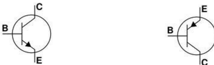
El de la izquierda es un transistor NPN y el de la derecha un transistor PNP.
