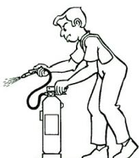
4) Dirigir el chorro a la base de las llamas con movimiento de barrido. En caso de incendio de líquidos proyectar superficialmente el agente extintor efectuando un barrido evitando que la propia presión de impulsión provoque derrame del líquido incendiado. Aproximarse lentamente al fuego hasta un máximo aproximado de un metro. En caso de espacios abiertos acercarse en la dirección del viento. Avanzar gradualmente desde los extremos.
