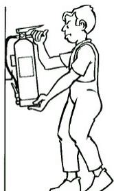
2) Agarrar la boquilla de la manguera del extintor y comprobar, en caso que exista, que la válvula o disco de seguridad (V) está en posición sin riesgo de proyección de fluido hacia el usuario. Sacar el pasador de seguridad tirando de su anilla. En caso de que el extintor fuese de CO<sub>2</sub> llevar cuidado especial al agarrar la boquilla por la parte aislada destinada para ello y no dirigirla hacia las personas.
