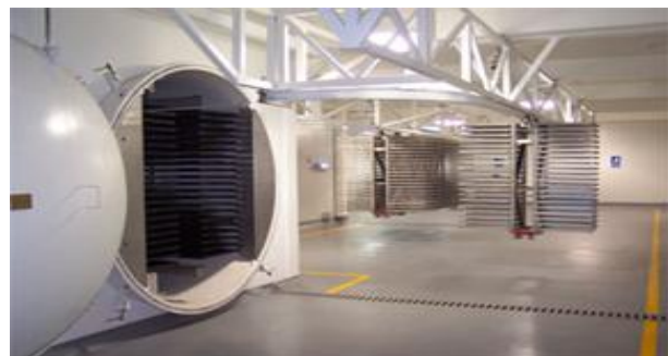
Sistema de carga y transporte de bandejas del liofilizador
