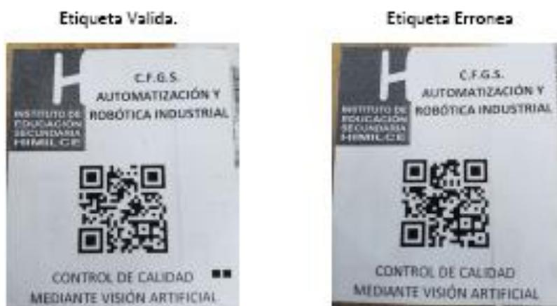
Si el sensor de visión detecta la etiqueta errónea, la caja al llegar al sensor inductivo detendrá la cinta y activará la baliza luminosa junto con el mensaje de error en el HMI.
