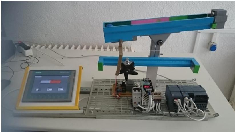
Se implementará un PID en el autómat S1200 para poder estabilizar la bola en una posición predeterminada por el alumno en una escala porcentual.
