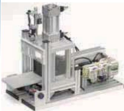
El módulo de prensa neumática puede prensar mitades de cubos. Después de depositar la pieza, se cierra la jaula de seguridad y se prensan las piezas con un cilindro neumático.
