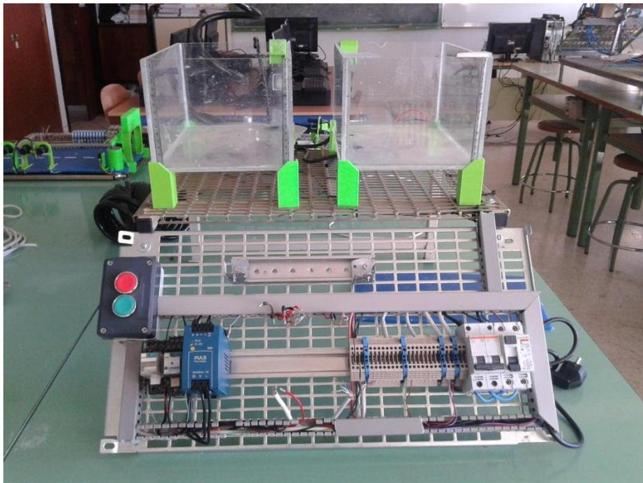
La maqueta cuenta con dos depósitos, un principal con líquido preparado para trasvasar al secundario. El trasvase es realizado por una electrobomba a 12 voltios alimentada desde fuente externa. **NO ALIMENTAR CON EL AUTOMATA. Se deberá conectar la alimentación de las electrobombas mediante contactor.**
