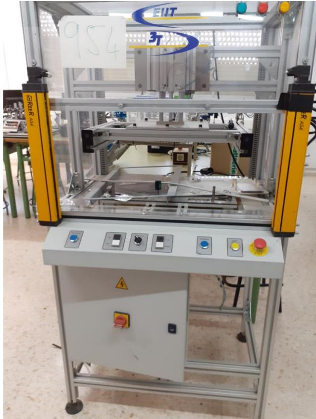
Se deberá realizar una adaptación del autómeta S1200 para esta máquina de comprobación de placas, utilizando todos los elementos disponibles, barrera de protección, señalizadores cilindros, etc. Se implementará un proceso industrial mediante accionamiento de botones, simulando la comprobación de placas electrónicas.
