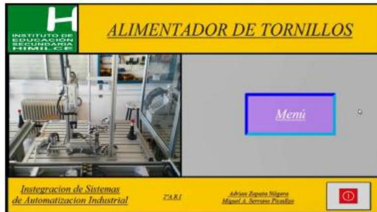
**2ª.- Pantalla control:** Botones de marcha, (modos manual, semiautomático y automático), botones de emergencia (Parada de ciclo, parada de etapa etc), según especificaciones de cada propuesta de ejercicio.) Se deberá incluir ventanas emergentes para controlar (accionar, apagar) y poder conocer el estado de válvulas, motores etc.
