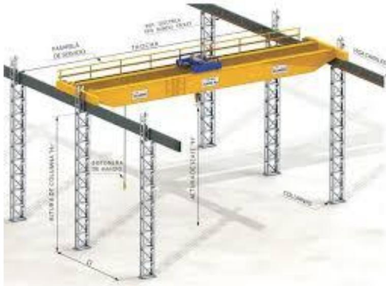
Se deberá diseñar una maqueta para la simulación de un puente grúa, en el que las posiciones deberán estar controladas con motor con ENCODERS incorporados, para poder determinar con exactitud donde recoger una carga y donde soltarla, estas coordenadas deberán ser insertadas en una pantalla SCADA.
