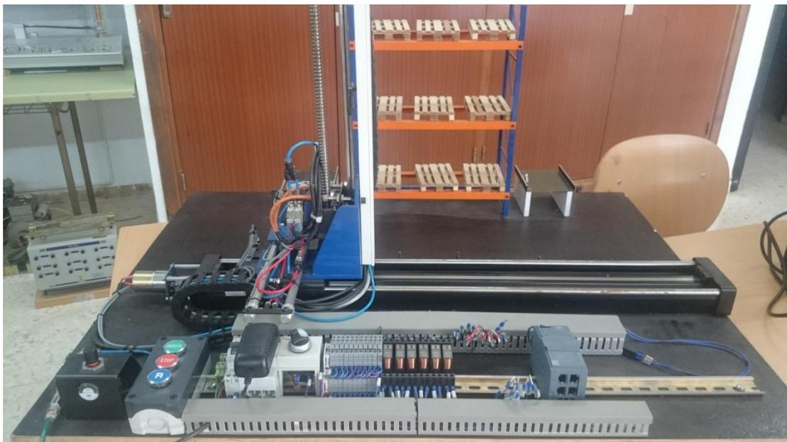
Esta maqueta realiza el almacenamiento de PALETS de forma automática o de forma manual, según modo de funcionamiento. Dispone de una zona de recogida, donde se deposita el PALET que se quiere almacenar (izquierda de la maqueta), y otra zona donde, una vez agotado el tiempo de almacenamiento o por orden expresa, se extrae de la zona de almacenamiento y se deposita en la zona de carga. (Derecha de la maqueta).
