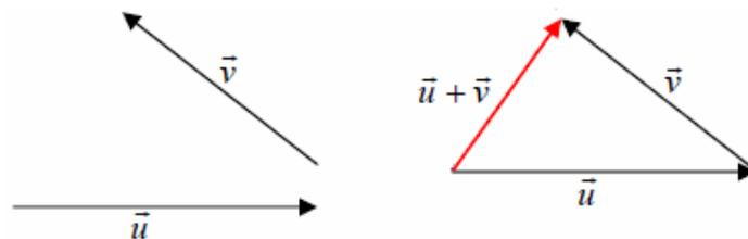
Analíticamente, dados  $\vec{u} = (u_1, u_2, u_3)$ ,  $\vec{v} = (v_1, v_2, v_3) \Rightarrow \vec{u} + \vec{v} = (u_1 + v_1, u_2 + v_2, u_3 + v_3)$
