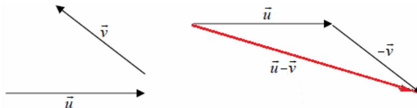
Analíticamente, dados  $\vec{u} = (u_1, u_2, u_3)$ ,  $\vec{v} = (v_1, v_2, v_3) \Rightarrow \vec{u} - \vec{v} = (u_1 - v_1, u_2 - v_2, u_3 - v_3)$
