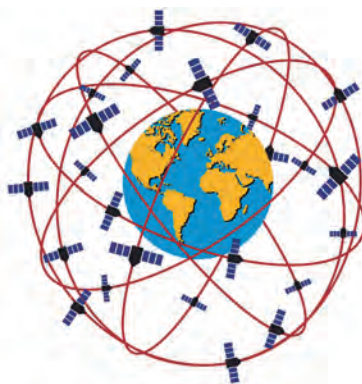
Figura 10. Órbitas de los 24 satélites que forman la constelación GPS con la que obtenemos coordenadas de puntos sobre la superficie terrestre.
