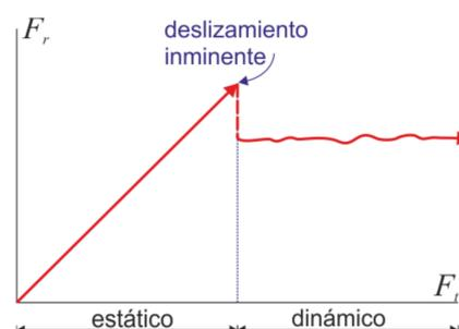
El coeficiente de rozamiento es un valor constante que se determina experimentalmente y que recoge la influencia de la naturaleza de las superficies y su grado de pulimentación.
