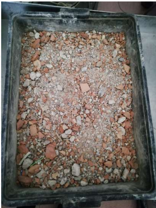
Restos de ladrillos, vidrio
