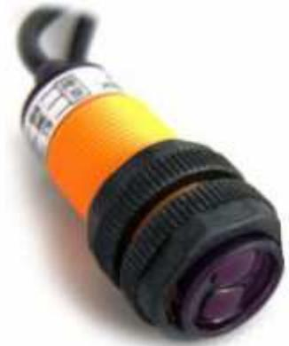
El dispositivo integra tanto al emisor como al receptor de infrarrojos. El emisor manda un haz de infrarrojos; si algún objeto pasa en esos momentos frente al sensor los rayos rebotarán e incidirán sobre el receptor, que genera la señal. Su funcionamiento es: si detecta un objeto en su campo de detección aporta un valor de tensión bajo (LOW) por su pin de señal. Si no detecta obstáculo aporta un valor de tensión alto (HIGH).
