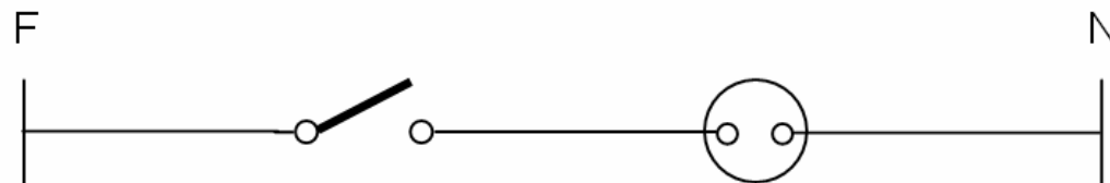
Toma de corriente sin TT activada desde interruptor
