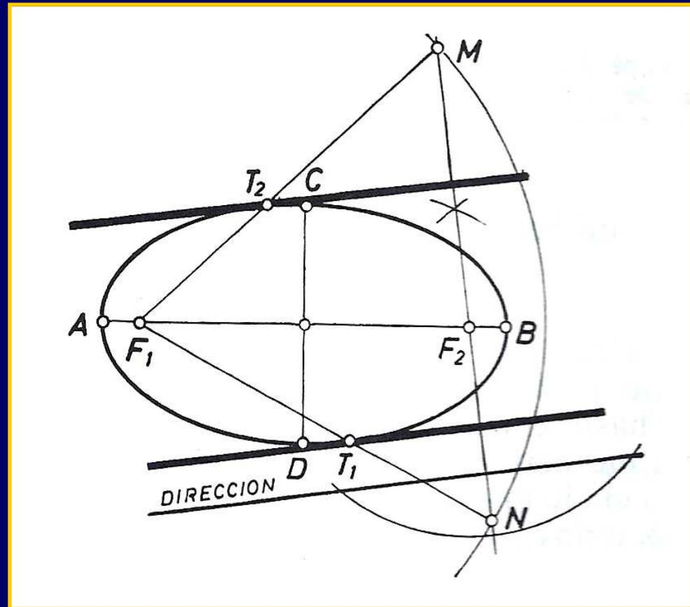
Los **puntos de tangencia** se hallan uniendo  $N$  y  $M$  con el otro foco ( $F_1$ ) obteniéndose  $T_1$  y  $T_2$  respectivamente.
