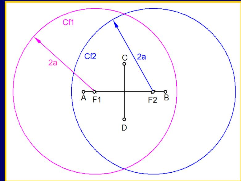
**Propiedad:** los puntos simétricos de un foco de la elipse respecto a cualquier recta tangente a la misma se encuentran situados en la circunferencia focal del otro foco.
