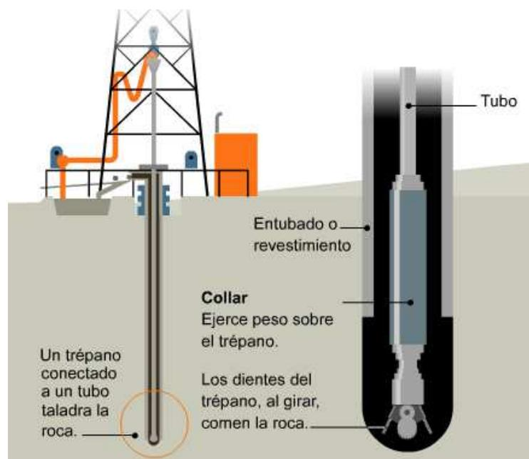
**de perforación**, que al girar va rompiendo la roca. A este tubo se le van acoplando nuevos tramos de tubo conforme se profundiza. Las paredes del pozo se van revistiendo también con tubos de acero.
