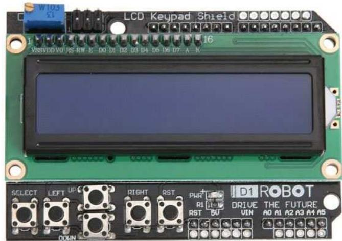
Si en lugar que montar nuestro escudo sobre una placa Arduino UNO, que queda totalmente cubierta, lo hacemos sobre una placa Arduino MEGA, disponemos de gran cantidad de pines al descubierto para conectar otros elementos.
