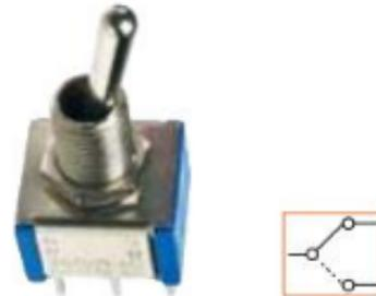
**Conmutador.** Es un interruptor que permite controlar el paso de la corriente por dos circuitos, abriendo uno de ellos y cerrando el otro.
