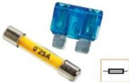
**Fusible.** Se conectan en serie en las instalaciones eléctricas y están formados por un hilo conductor que se funde cuando la intensidad de corriente sobrepasa un cierto valor.
