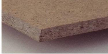
**Tableros de fibras:** formados por madera triturada, mezclada con adhesivo y prensada en caliente.
