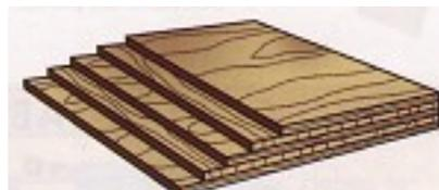
**Tableros aglomerados:** se elaboran con un 90% de virutas y un 10% de cola prensadas en caliente.
