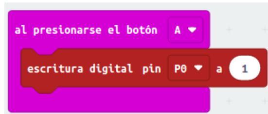
**PG17.** Pulsador exterior con memoria y botón de apagado. Al darle a un pulsador exterior, conectado al PIN 0, se encienden todos los LEDs de la matriz. Se apagan al darle al botón «A».
