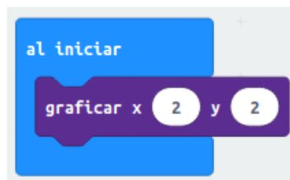
**PG7.** Encendido y apagado de diodos LED determinados.
