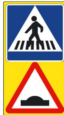
Fotomontaje de conjunto de señales verticales a instalar junto a paso peatonal.
