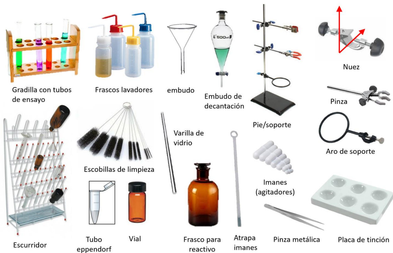
Figura 3.4. Otros materiales útiles para el trabajo en un laboratorio químico. La limpieza y el orden son fundamentales en el funcionamiento de un laboratorio químico. El material debe estar limpio y seco antes y después de su uso. Nos ayudaremos, por lo general, de agua con jabón y las escobillas para lavar el material.
