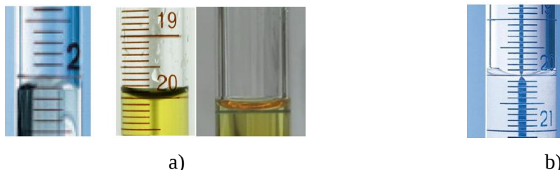
Figura 4.2.2. Cuando el líquido se adhiere a la superficie del material de vidrio se forma un menisco convexo. Cuando no tiende a adherirse forma un menisco cóncavo.
