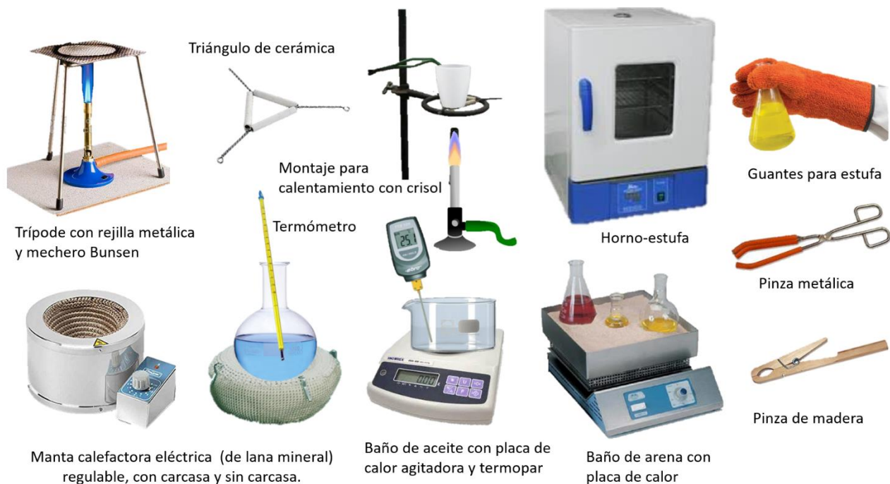
Figura 3.3. Material común empleado para calentar. Estos procesos deben estar controlados y asegurarse que todo el material está en buen estado antes de iniciar el calentamiento.
