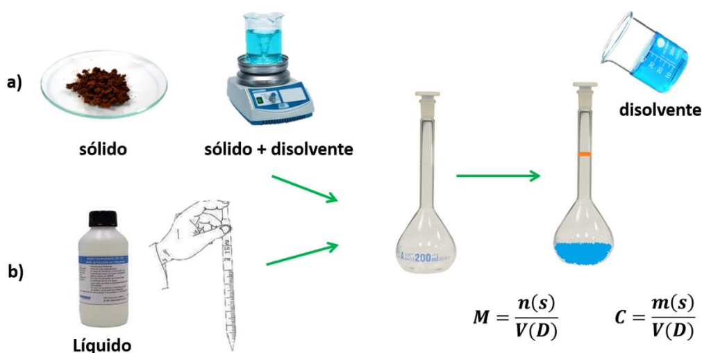
Figura 4.2.1. a) mezcla de un sólido soluble en un líquido; b) mezcla miscible líquido-líquido. Para expresar la concentración de una disolución se usa normalmente la molaridad (mol/L).
