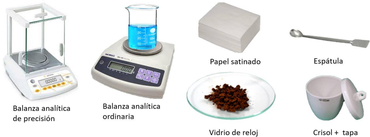
Figura 3.1. Material empleado para medir la masa de una sustancia sólida o líquida. Normalmente se da en gramos (g), miligramos (mg) o microgramos ( \mu\text{m} ).
