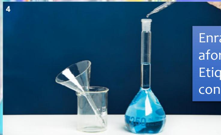
Enrasar el matraz hasta el aforo. Etiquetar con la sustancia, concentración y fecha.
