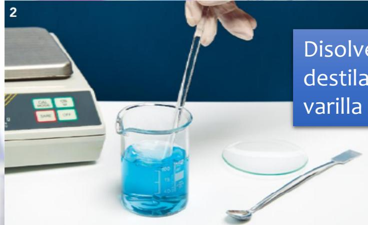
Disolver el soluto en agua destilada, agitando con una varilla de vidrio.
