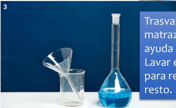
Trasvasar la disolución a un matraz aforado con la ayuda de un embudo. Lavar el vaso de precipitado para recoger cualquier resto.
