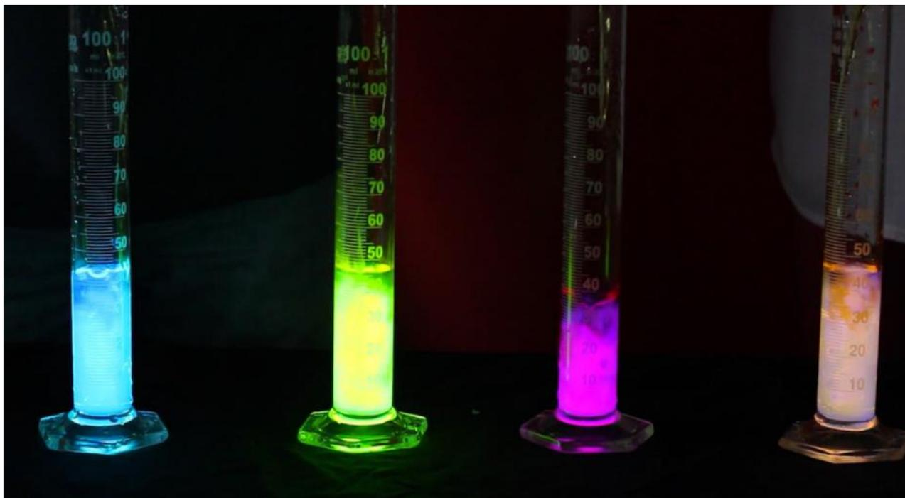
**Esquema 6.** FRET del luminol con otras sustancias fluorescentes. (1) Luminol; (2) fluoresceína; (3) Rodamina G; (4) Eosina.
