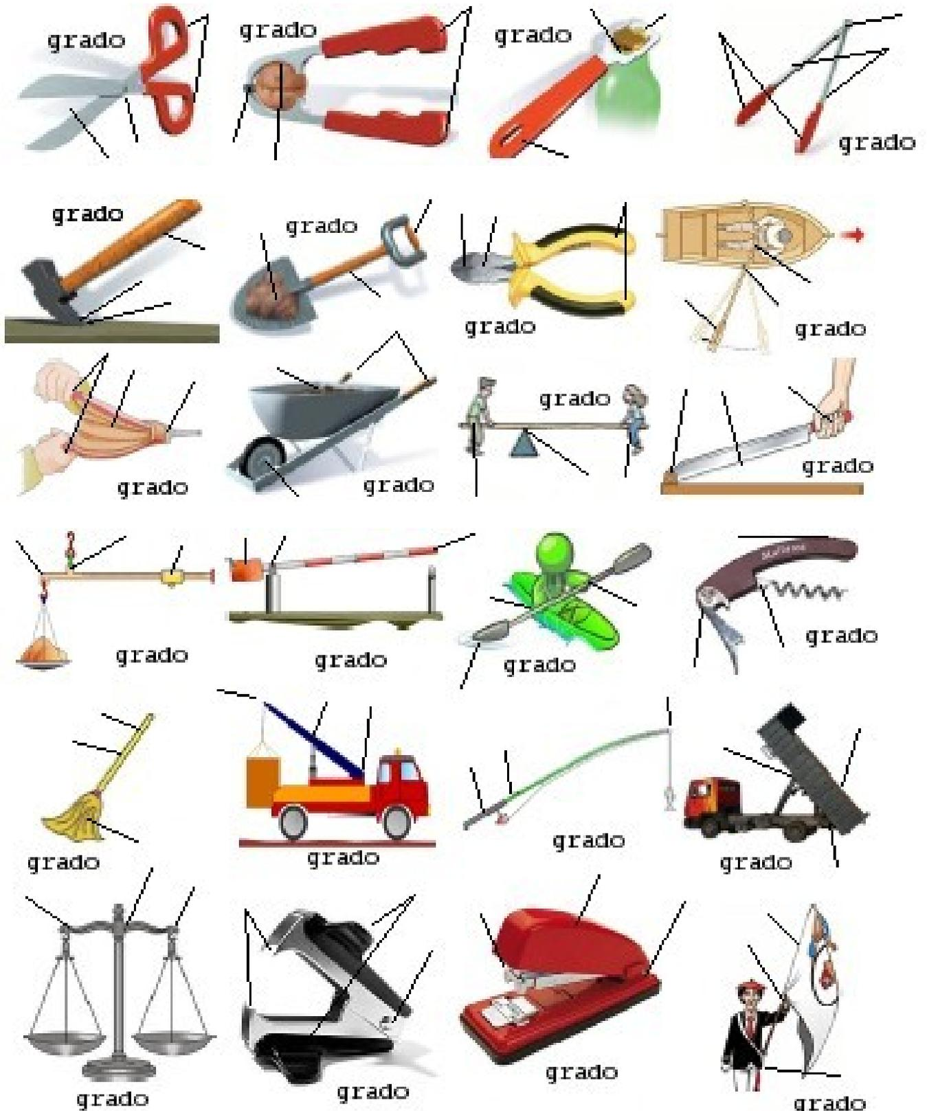
Fíjate en el siguiente esquema: se trata de una palanca simple de primer grado. En ella se representa la **fuerza aplicada (F)**, la **resistencia (R)** y el **punto de apoyo**. Por otra parte, se identifica también:
