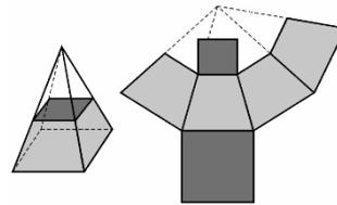
El área lateral de un tronco de pirámide de bases paralelas es la semisuma de los perímetros de las bases por la apotema
