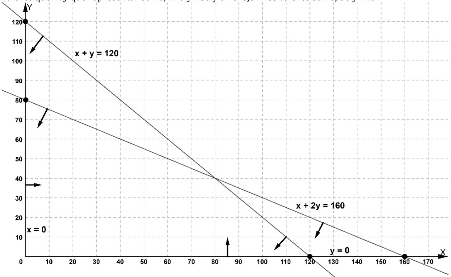
Obtención de la región solución del sistema de inecuaciones y cálculo de los vértices:
